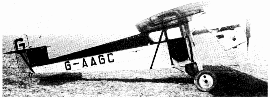
Boven en onder: FK.41 met 100 pk Cirrus motor (staande cilinders)
